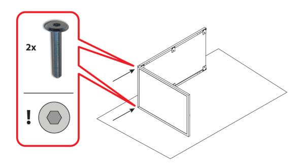
Fixez le dessus à la partie latérale de l'extérieur à l'aide des deux vis (fournies) Fix the top to the side-part from outside, using the two screws (supplied)
