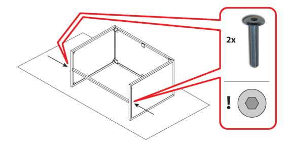
Fixez la traverse / barre inférieure de l'extérieur à l'aide des deux vis (fournies) Fix the lower cross/bar from outside, using the two screws (supplied)
