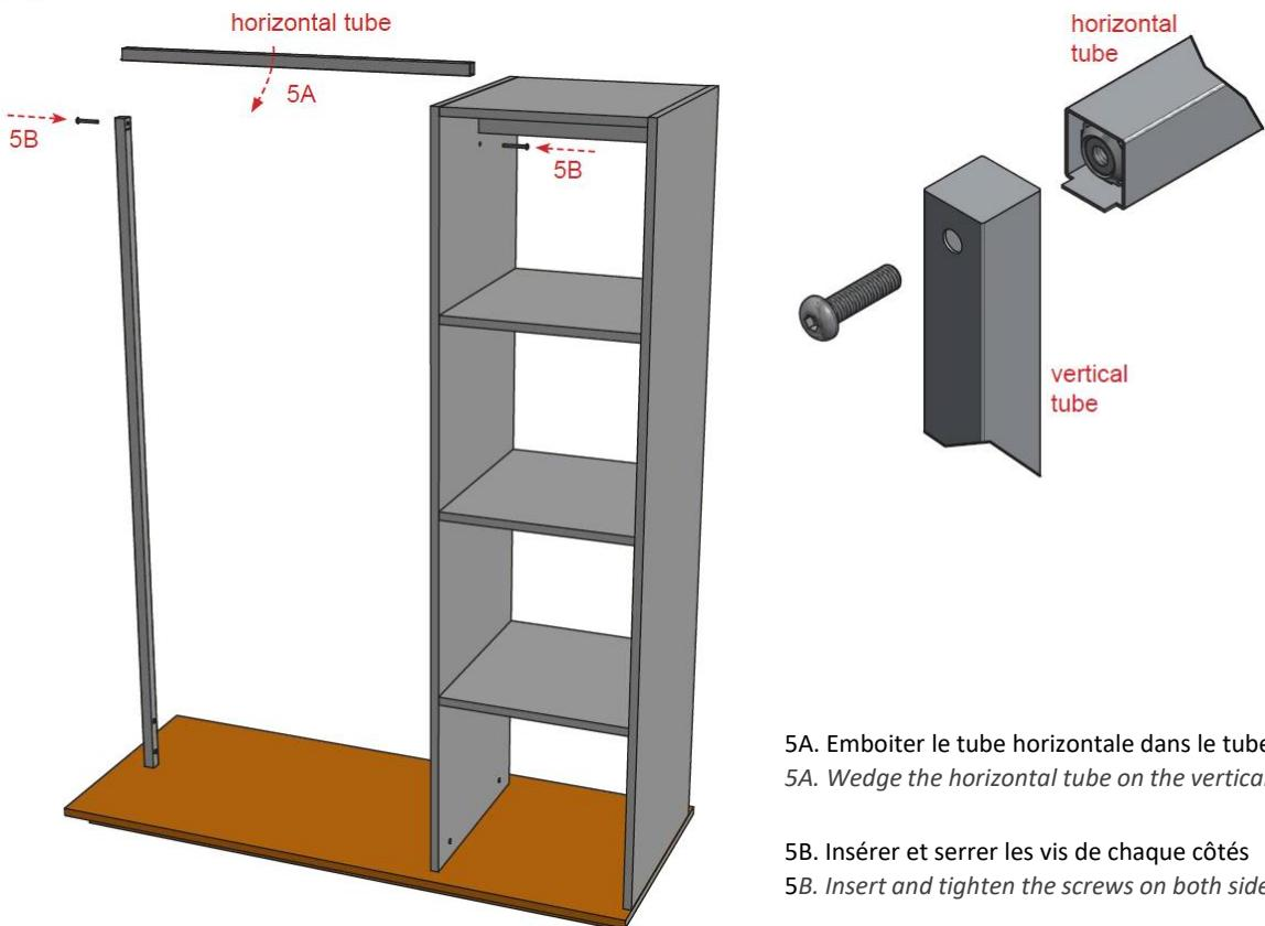
5A. Emboiter le tube horizontale dans le tube vertical
