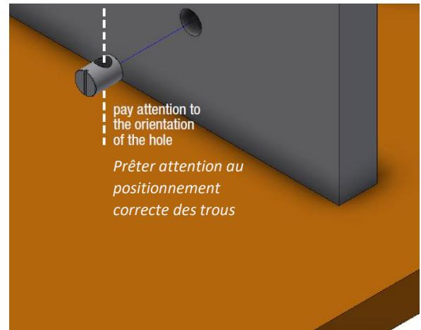
3A. Insérer le cylindre de blocage dans les trous du module étagère
